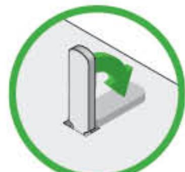
**EN** Bend the eyelet by 90 degrees **UA** Зігнути вушко на 90 градусів **PL** Zgiąć uszko o 90 stopni **IT** Piegare occhiello di 90 gradi **DE** Die Öse um 90 Grad biegen **FR** Plier l'attache de 90 degrés **ES** Doblar el orejo 90 grados **RU** Согнуть ушко на 90 градусов **CN** 弄弯耳子90度 **KR** 끝 부분을 90도로 구부려 주세요 **JP** アイレットを90度曲げます **AR** قم بشني العروة بزاوية 90 درجة
