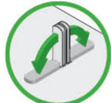
**EN** Unbend the eyelet by 90 degrees **UA** Розігнути вушка на 90 градусів **PL** Rozgiąć uszko o 90 stopni **IT** Raddrizzare occhielli di 90 gradi **DE** Die Öse um 90 Grad zurückbiegen **FR** Plier les attaches de 90 degrés **ES** Enderezar los orejos 90 grados **RU** Разогнуть ушки на 90 градусов **CN** 弄直耳子90度 **KR** 끝 부분을 90도로 펴 주세요 **JP** アイレットを90度伸ばす **AR** قم بفرد العروة بزاوية 90 درجة
